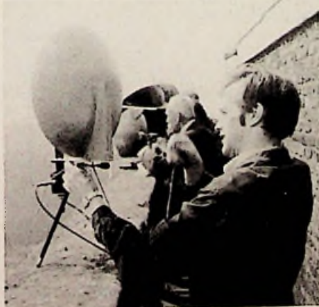
Afb. 3. Duplex straalverbinding op de kerktoeren van Monnickendam.
