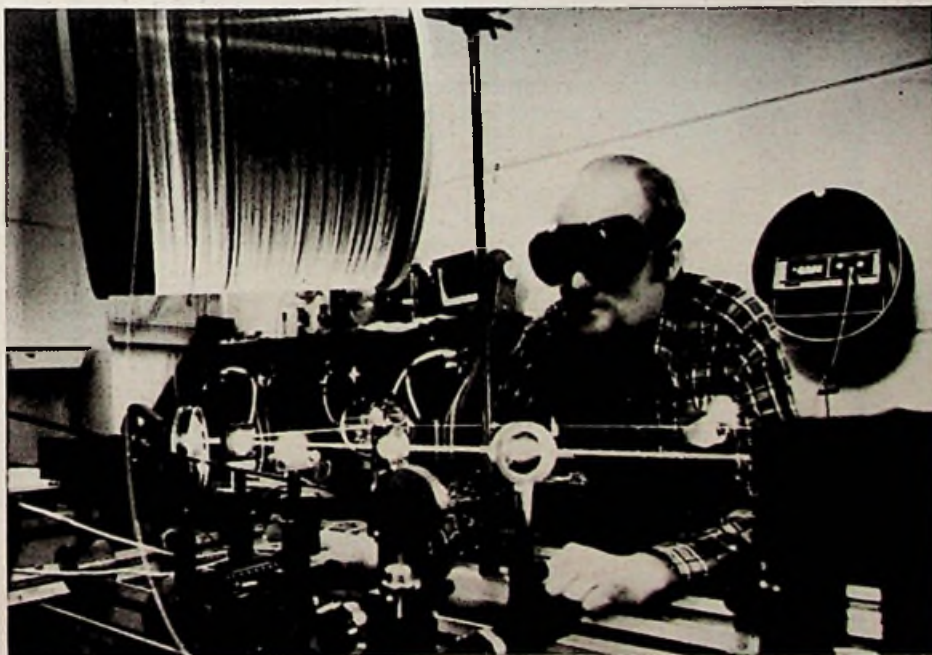
Vezeloptica opent nieuwe vooruitzichten voor informatieoverdracht, maar vereist ook geheel nieuwe onderzoeksmethoden. Deze opname uit het onderzoeksinstituut van AEG-Telefunken in Ulm gunt ons een blik in een laboratorium waar op een trommel gewikkelde optische vezels op hun overdrachteigenschappen worden onderzocht. In de zender is een laserdiode met groot nuttig effect toegepast. Gestreefd wordt naar een hoog overdrachtsgehalte met als bijkomende voordelen goede modulatiemogelijkheid en emissie van smalle spectraalbanden. (foto AEG Telefunken)
