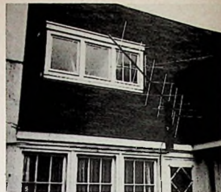
Afb. 2. Definitieve „vaste" opstelling van de gekruiste yagi-antenne. Hierop is ook te zien dat de verticale gamma niet loodrecht op het aardoppervlak staat maar onder een hoek van ca. 15^\circ . De gehele antenne maakt tevens een hoek van ca. 8^\circ met de aarde, gericht op ATS-3.
